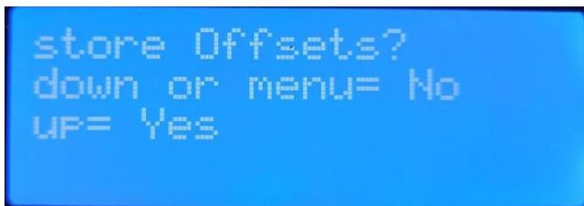
Durch einen weiteren Druck auf die Menü Taste kommt man in den Speicherbereich der Offsets.
