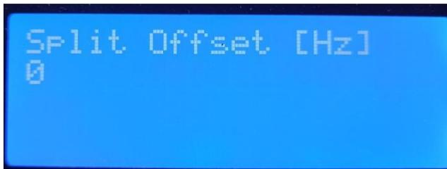
Durch einen weiteren Druck auf die Menü Taste kommt man in den Einstellbereich eines Split-Offsets.
