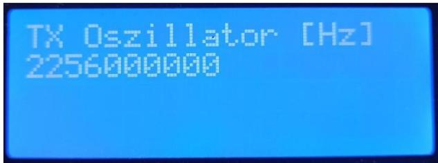
Durch einen Druck auf die Menü Taste kommt man in den Einstellbereich der TX-Oszillatorfrequenz.
