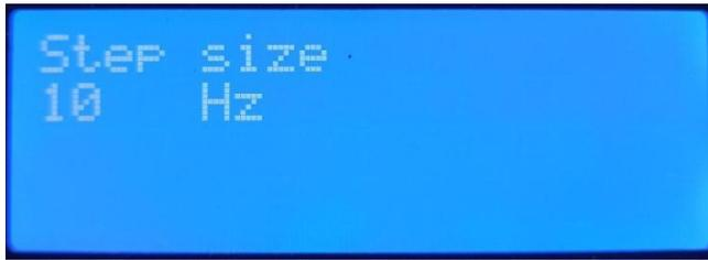
Durch einen weiteren Druck auf die Menü Taste kommt man in den Einstellbereich der Schrittweite.
