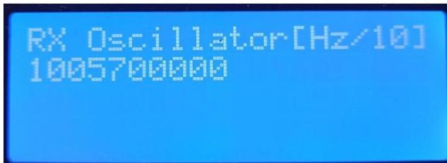
Durch einen weiteren Druck auf die Menü Taste kommt man in den Einstellbereich der RX-Oszillatorfrequenz.
